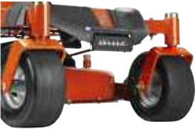
Kit luci opzionale per una maggiore visibilità anche in condizioni di scarsa luminosità. Per il modello Z242F.
